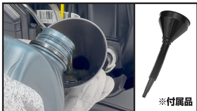
④本機を水平に保持し、付属のじょうごで新しいエンジンオイルを規定量(注入口の口元まで)給油します。
